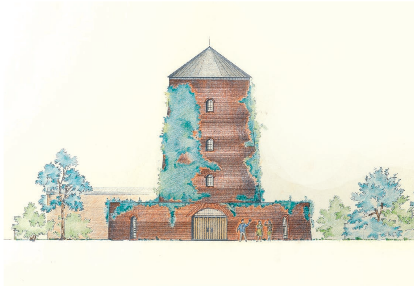
Zeichnung des Mühlen- zustandes aus dem Jahr 1979. Efeu hatte dem Mauerwerk und dem Fundament bereits erheblich zugesetzt.
